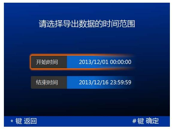
时间范围设置完成后,按下"#"键确认,即可将所选时间段内的用户记录导出到 U 盘。
