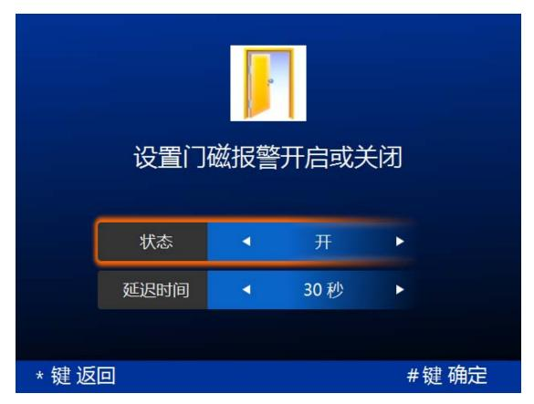
延迟时间:指门锁关闭一段时间后如果检测到门还没有关闭就将发出报警信号。
