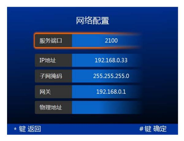
手动完成服务端口、本机 IP 地址、子网掩码、网关的设置。
