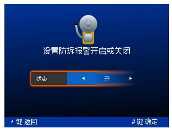
注 1: 为确保设备发出防拆报警时本设备能发出报警声音,请确认打开"本机报警声音"设置,见 6.2.4 声音设置。
