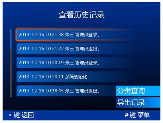
按下"OK"键,进入输入查询条件界面,选择需查询的用户名,事件类型,开始时间和结束时间进行查询,如图:
